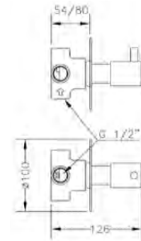
Ref.: 63114 30 45 66 Inversor cerámico 3 vías empotrado placa redonda Built-in 3 way ceramic diverter with round plate
