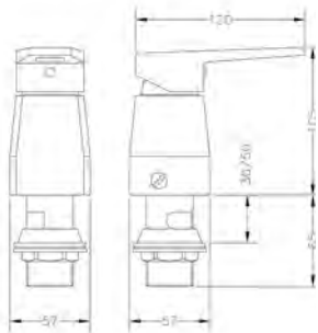
Ref.: 64142 14 45 66 Monomando de bidé con transmisión Single lever bidet mixer with diverter
