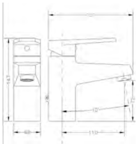
Ref.: 64130 04 45 66 Monomando de lavabo apertura en frío Single lever wash-basin mixer cold start
